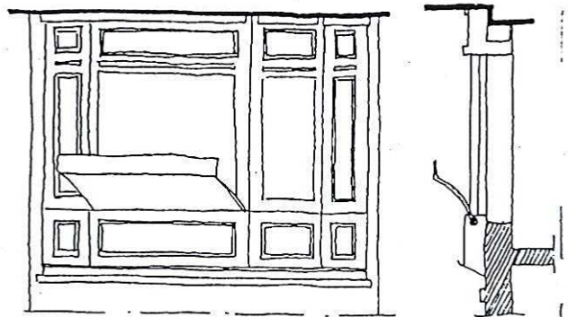
3- Store dissimulé dans le coffrage
